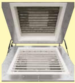
炉底和炉顶加热, 两区控制
