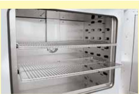
可拔出的格形栅板，用于在不同的装载层对烘干箱进行装载
