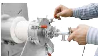
不锈钢水冷法兰额外配备快速锁
