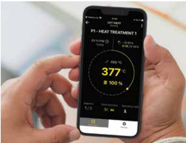
显示每个炉子的程序进度
