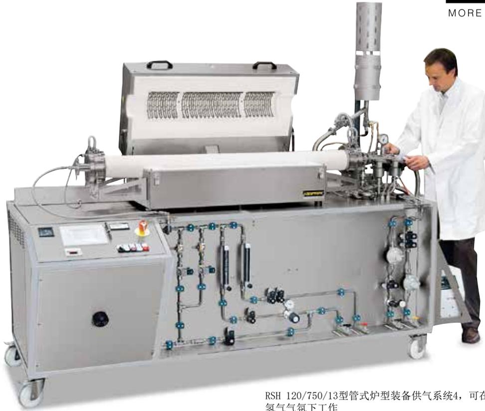
RSH 120/750/13型管式炉型装备供气系统4，可在氢气气氛下工作
