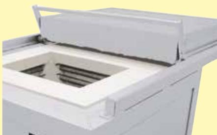
井式炉 S 73/HS 带滚轮盖板
