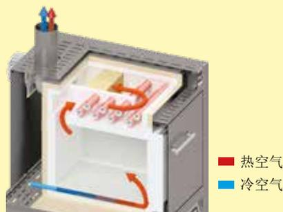
L 24/11 B0型灰化炉中的空气导向示意图
