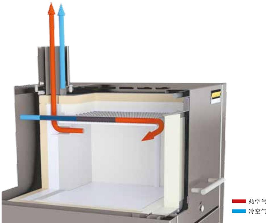
应用于灰化炉的进气和排气原理
