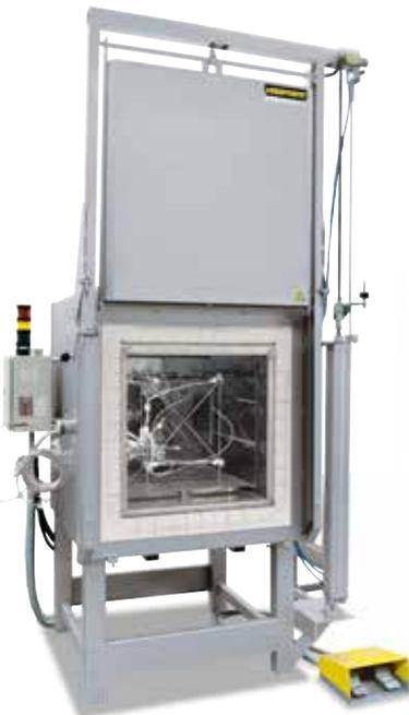
用来测量温度均匀性的测量架
