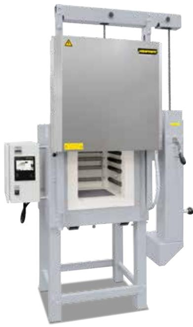
配有手动升降门的LH 30/12型箱式炉
